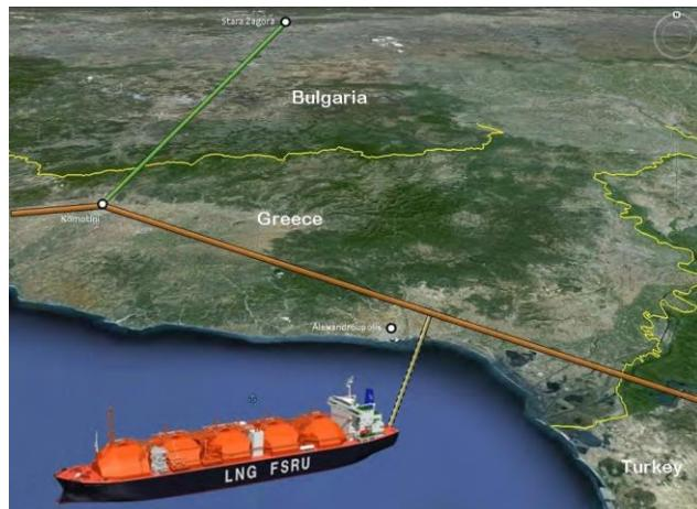
Plutajući terminal za prijem, skladištenje i regasifikaciju (FSRU) imaće ukupan kapacitet isporuke od 5,5 milijardi kubnih metara godišnje. Gas će se odatle podmorskim i kopnenim segmentima gasovoda transportovati u grčku mrežu prirodnog plina, piše **Offshore Energy**.
