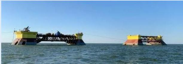
"Brodogradilište u Astrahanu koje je izgradilo i montiralo konstrukciju primenilo je posebnu rusku tehnologiju metalizacije trupa koja jamči dugotrajan rad podkonstrukcije i sprečava koroziju", saopšteno je u utorak iz Lukoila.
