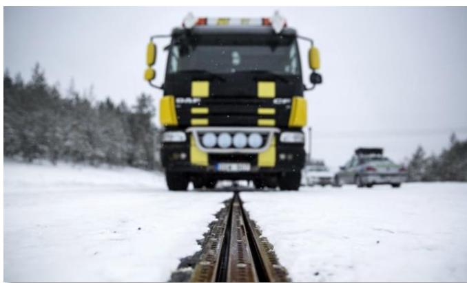
Naime, vozila se mogu povezati na "električnu" šinu (na slici gore) koja je ugrađena u put.
