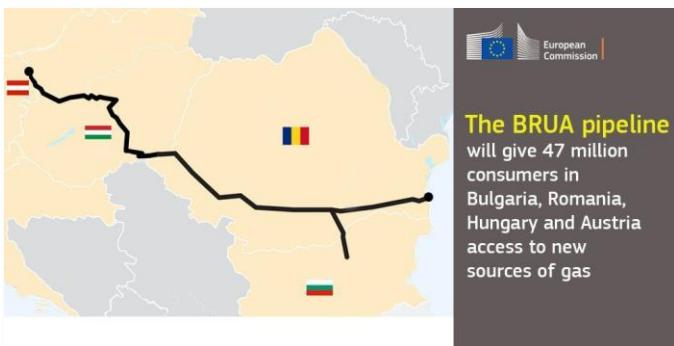
Kapacitet gasovoda će biti 1,5 milijardi m<sup>3</sup> u smeru prema Bugarskoj i 4,4 milijarde m<sup>3</sup> u smeru prema Mađarskoj. Ideja je da se ovim pravcem obezbede alternativni pravci snabdevanja gasom i povećanje energetske sigurnosti u Srednjoj i jugoistočnoj Evropi.
