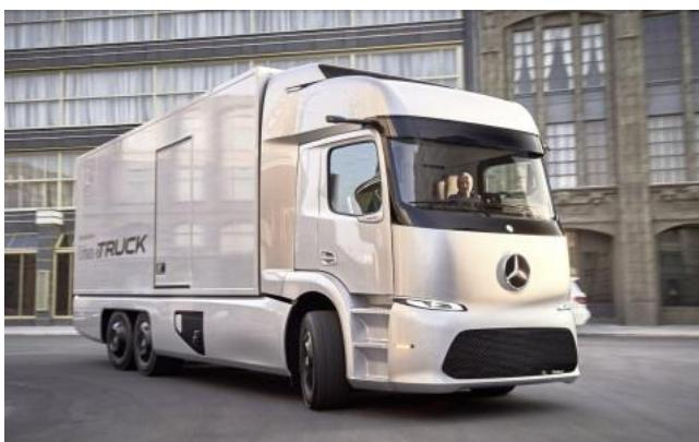
U ponudi će biti dve veličine kamiona (18 i 25t), a kupcima se nude verzije sa klasičnim tovarnim prostorom, hladnjače ili platforme. Kamion ima doseg od oko 200 km, 212 kWh baterije napajaju dva elektromotora snage 250 kW i maksimalnog obrtnog momenta od 1.000 Nm.
